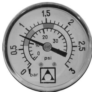
0,8 kg/cm 2 - 11,4 PSI: Normaldruck bei Beginn des Filtriervorganges.
