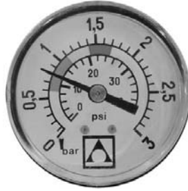
0,8 kg/cm 2 - 11,4 PSI: filitreleme sürecinin başındaki normal basınç
